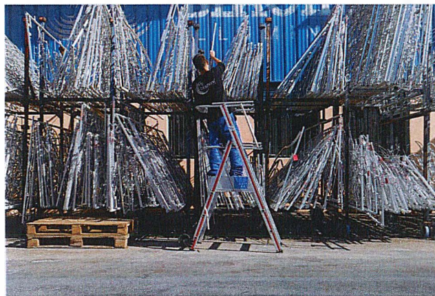
Opérateur utilisant une plate-forme individuelle roulante pour ranger des éléments de structures
